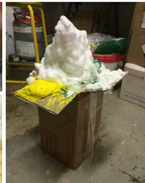
Fig 43. Espace de test et de déchets pour les mousses *Bold* - notamment en vue d'évaluer le volume d'expansion entre la matière liquide sous pression et la mousse produite, 2016.
