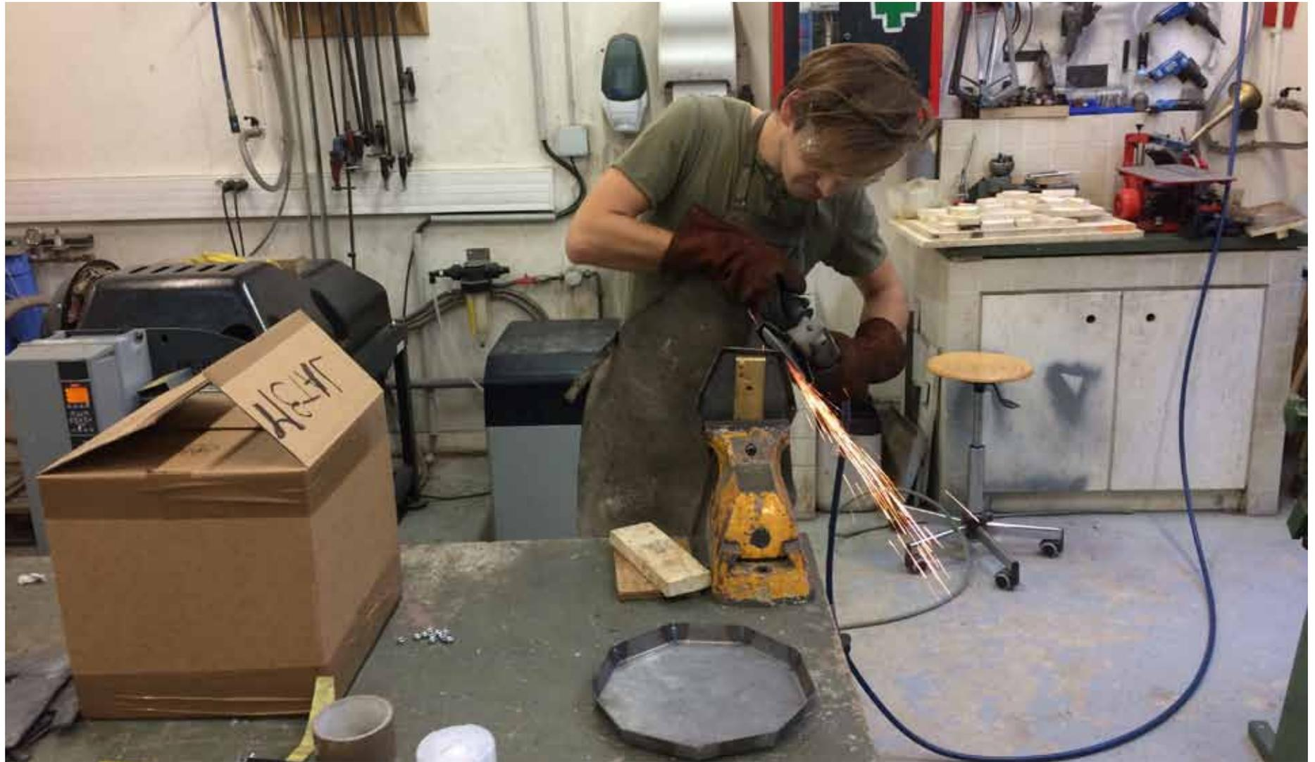
Fig 3. Utilisation d'une meuleuse pour nettoyer les soudures au MIG pour un moule, atelier Métal de l'EnsAD, 2016.
