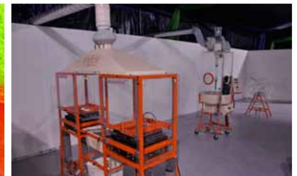
Fig 12. Seconde machine Polyfloss (baptisée Rafale) fonctionnant au gaz et système de collecte sur un tube monté sur une perceuse.
