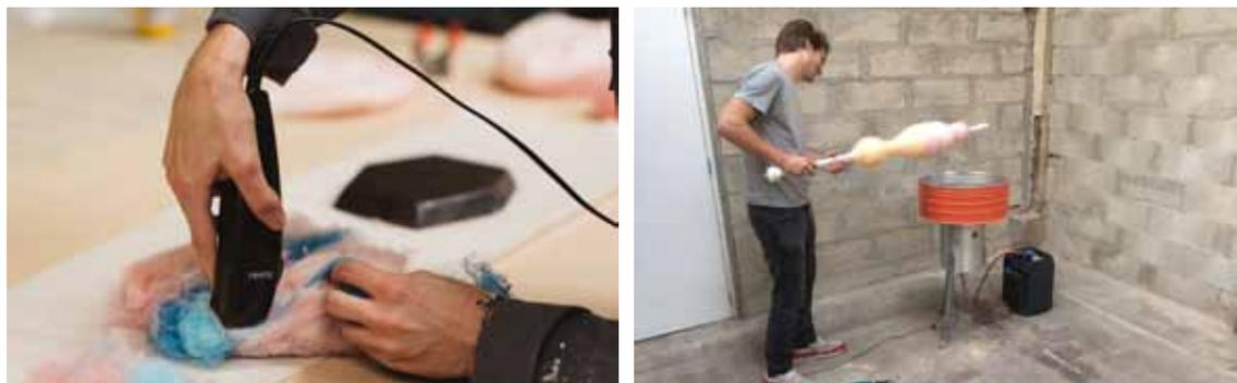
Fig 34. Fabrication de matière Polyfloss par enroulement des fibres sur un bol monté sur une perceuse. Plus la vitesse de rotation est importante, plus les fibres sont fines, mais risquent de se désolidariser.
