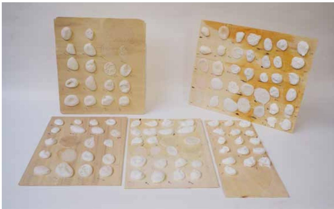
**Bold** est un outil d'extrusion de mousse aqueuse prenant la forme d'une bombe aérosol de peinture de graffiti. Elle permet de créer des formes colorées en trois dimensions qui se solidifient par séchage, dans l'objectif d'une création urbaine éphémère. Le principe chimique du projet *Bold* repose sur l'association des composants de la mousse à raser et de la peinture à base d'eau. *Projet en cours de finition - il donnera lieu à des objets et une installation.*
