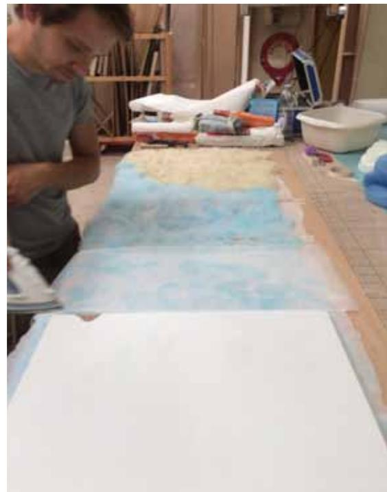
Fig 18. Refonte de matière *Polyfloss* avec l'aide d'un fer à repasser pour obtenir des surfaces moirées, 2017.
