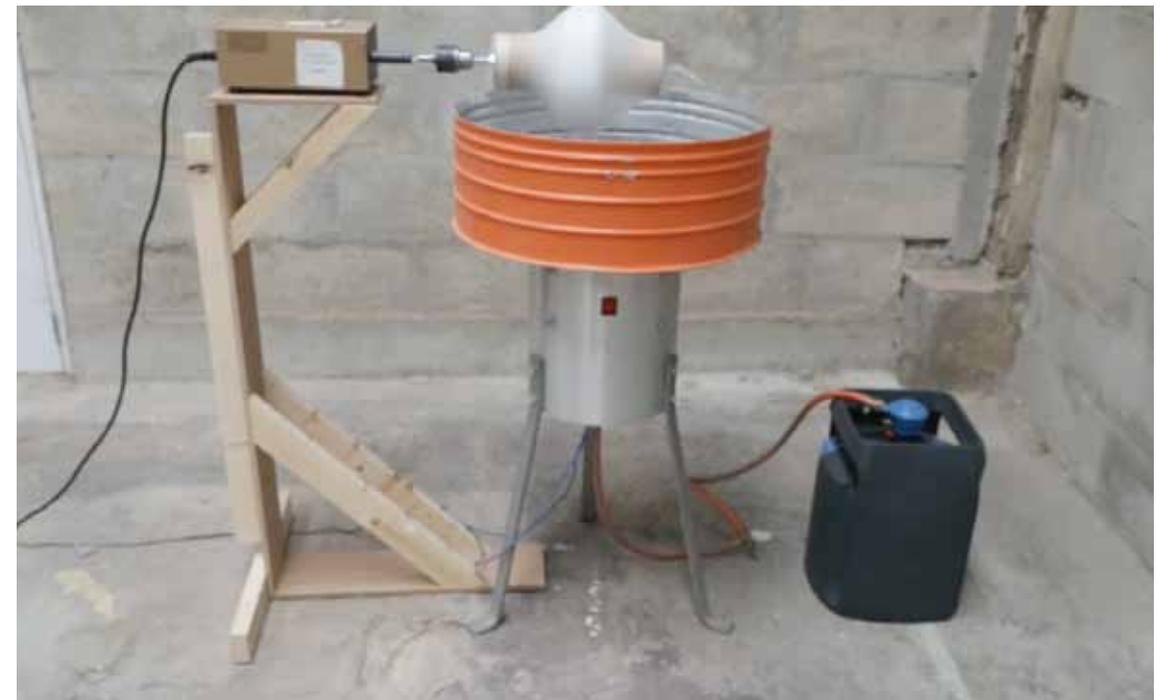
Fig 4. Première installation permettant de centrifuger du plastique à chaud, dans les ateliers de l'Imperial College, 2011.
