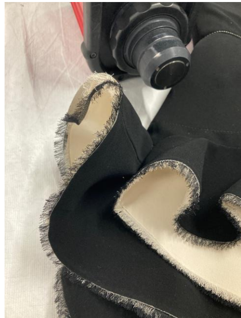
Balenciaga, collection Printemps/Ete 2013 Robe entièrement thermoformée présentant des délaminations Analyse d'identification des fibres au spectromètre à infrarouge (FTIR) en cours
